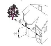
Montagehöhe (D): 2 - 3 m. Wir empfehlen für die optimale Überwachung eine Höhe von 2,5 m auf festem und ebenem Untergrund.
