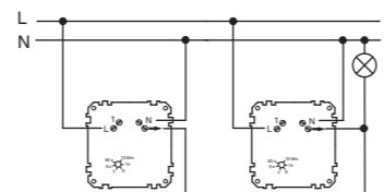
– Universele relaisokkel (A) in nevenaansluiting met mechanische impulsdrukker (B) (willekeurig aantal) en/of elektronisch neventoestel (C) (max. tien).
