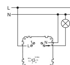
– Twee universele relaisokkels (willekeurig aantal mogelijk) parallel geschakeld. De verbruiker wordt geschakeld als een van de universele relaisokkels schakelt:
