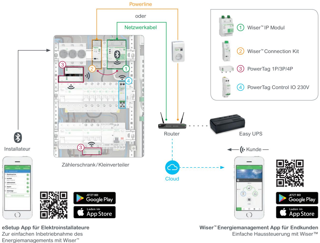
Das IP Modul und die PowerTag-Energiesensoren sind mit Wiser™ kompatibel.
