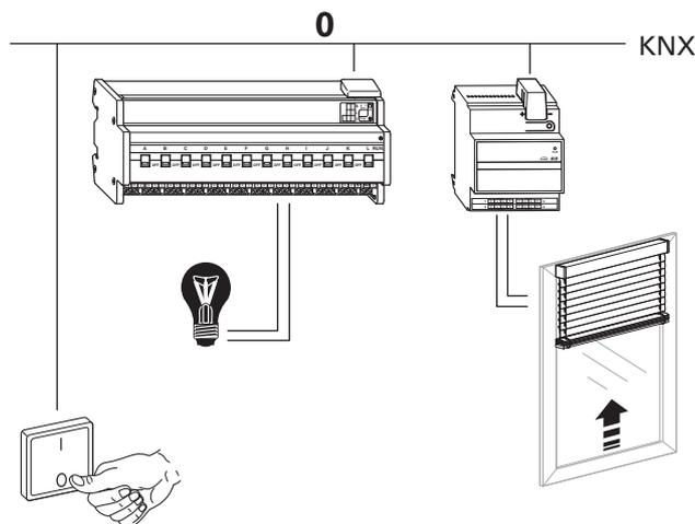
Da der Rollladen zum Öffnen eine gewisse Laufzeit benötigt, sollte das Licht in diesem Fall mit einer Ausschaltverzögerung ausgeschaltet werden, damit es in dem Raum nicht kurzzeitig dunkel wird.
