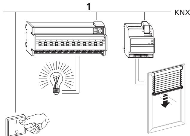
Tastendruck auf AUS => Telegrammwert „0“ => Licht AUS und Preset-Position 1 abrufen = Rollladen öffnen:
