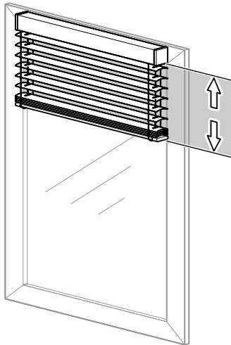
Bei aktiver Begrenzung bewegt sich der Antrieb nur noch zwischen den Grenzwerten. Die Begrenzung gilt für alle Fahrbefehle aus manueller Bedienung, Automatikfunktionen, Szenen, Presets und für Fahrbefehle aus Funktionen mit geringerer Priorität.
