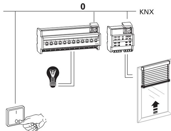
Da der Rollladen zum Öffnen eine gewisse Laufzeit benötigt, sollte das Licht in diesem Fall mit einer Ausschaltverzögerung ausgeschaltet werden, damit es in dem Raum nicht kurzzeitig dunkel wird.
