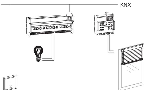
Die Presetfunktion lässt sich beispielsweise dazu nutzen, um über einen Taster gleichzeitig die Beleuchtung zu schalten und die Rollläden zu fahren. Wenn Sie für Preset-Position 1 den Wert 0 % (Rollladen geöffnet) und für Preset-Position 2 den Wert 100 % (Rollladen geschlossen) eingeben, dann können Sie über einen Taster folgendermaßen steuern:
