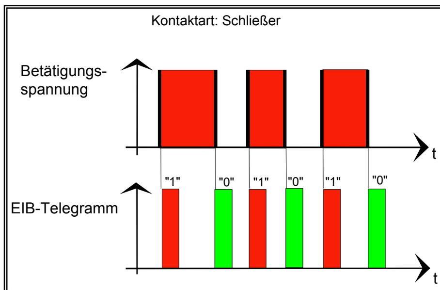
Abb. 6-24 Flanken: bei Betätigung 1, bei Loslassen 0
