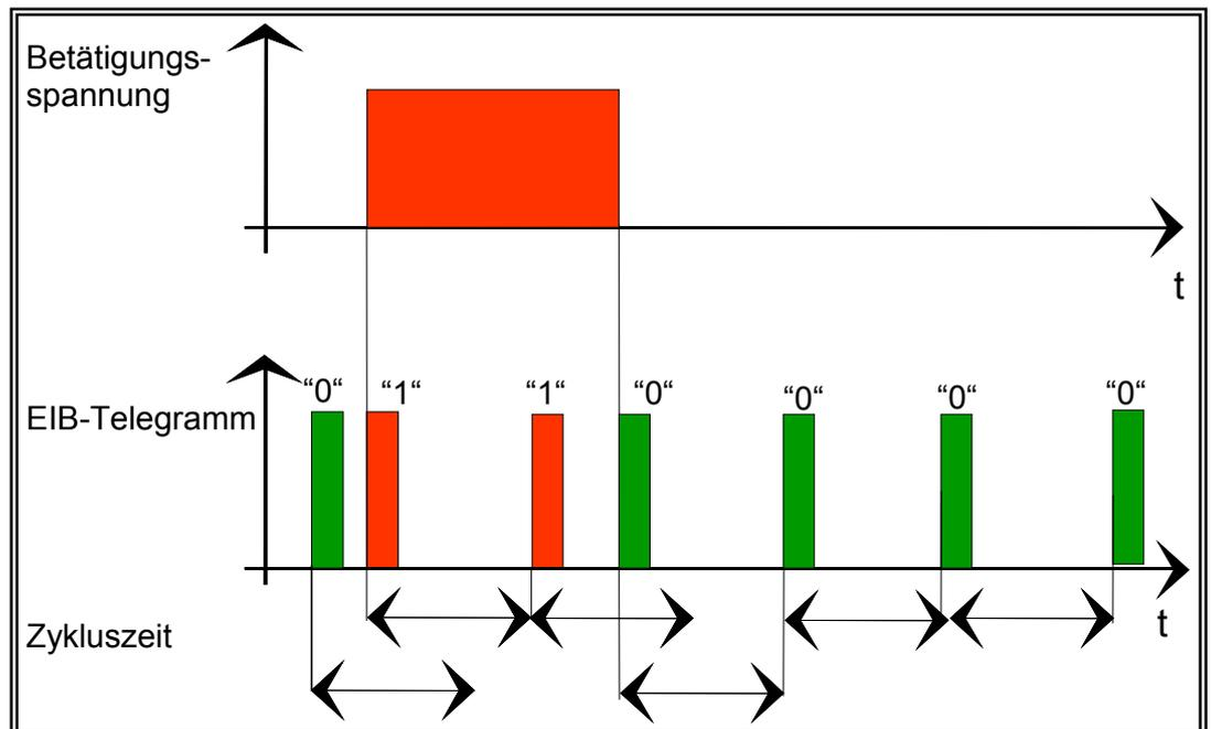
Abb. 6-14 Schließer: zyklisch: Betätigung EIN, Loslassen AUS
