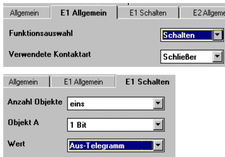
Abb. 6-7 schließend -> Wert: AUS-Telegramm
