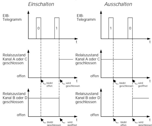
Werden zwei Kanäle zu einer Wechslerfunktion zusammengefaßt, so existiert nur ein Rückmeldeobjekt.
