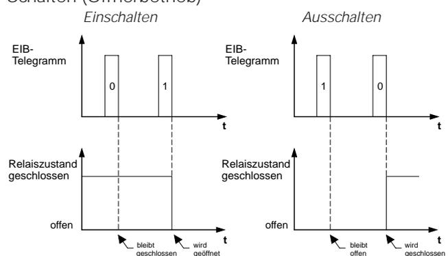
Nach Busspannungswiederkehr wird bei der Funktion "Öffner" das Relais geschlossen und bei aktivierter Rückmeldefunktion ein "1"-Rückmeldetelegramm erzeugt, wenn kein anderes Einschaltverhalten (z.B. durch übergeordnete Funktion oder Verhalten bei Busspannungswiederkehr) den Ausgang in eine geöffnete Position schaltet.
