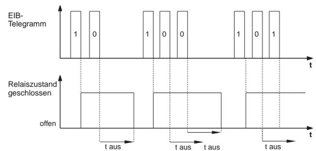
Wird der Ausgang des Aktors während einer laufenden Verzögerungszeit durch eine übergeordnete Funktion in eine neue Schaltstellung gesteuert, so schaltet das Relais unverzögert.
