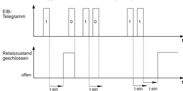
Wird der Ausgang des Aktors während einer laufenden Verzögerungszeit durch eine übergeordnete Funktion in eine neue Schaltstellung gesteuert, so schaltet das Relais unverzögert.
