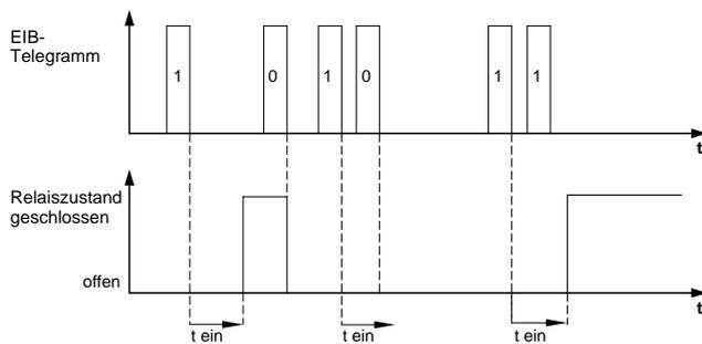
Schalten mit retriggerbarer Einschaltverzögerung (Schließer)
