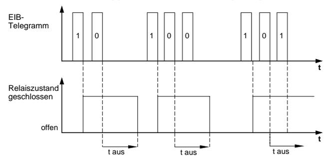
Schalten mit retriggerbarer Ausschaltverzögerung (Schließer)
