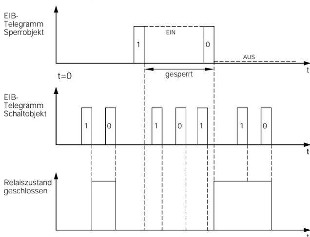
*Sperrfunktion bei: Sperrobject=0; Wert des Sperrobjects nach Busspannungswiederkehr: 0; Reaktion beim Sperren: betätigt; Reaktion beim Freigeben: folgt Schaltobjekt; Relais: Schließer*
