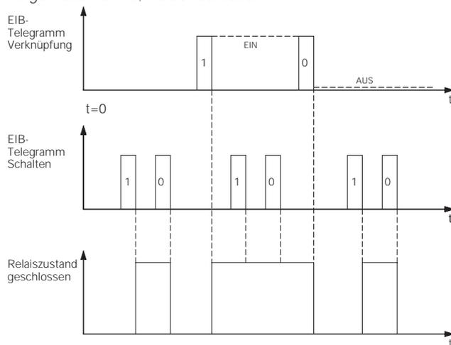
Nur wenn über das "Verknüpfungsobjekt" ein „0“-Telegramm empfangen wurde, kann das Relais über das "Schaltobjekt" ausgeschaltet werden.
