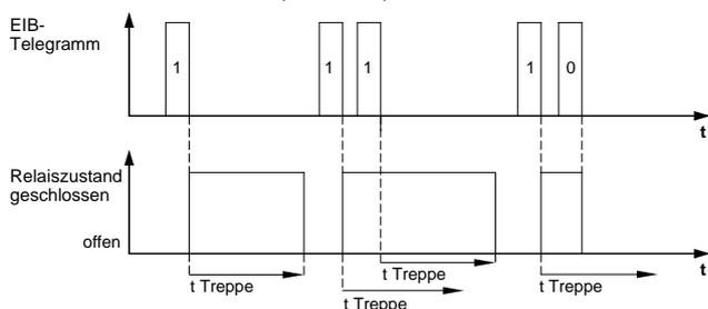
Nicht retriggerbare Treppenlichtzeitfunktion mit manuell-Aus-Funktion (Schließer)
