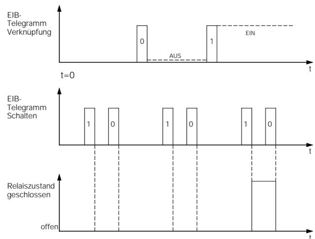
Die Parametereinstellung bewirkt ein Setzen des "Verknüpfungsobjektes" auf den Wert "0". Nach einem RESET wird der Aktor in der Betriebsart "Schließer" und diesen Einstellungen den Ausgang solange nicht schalten, bis auf dem "Verknüpfungsobjekt" ein "1-Telegramm" empfangen wurde.
