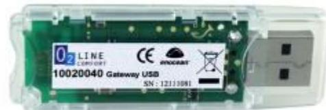
Bei diesem USB-Gateway handelt es sich um einen kleinen USB-Stick, der PCs, Verbrauchergeräte, DSL-Boxen und andere USB-Mastergeräte mit Funkprodukten von EnOcean verbindet. Er ist mit einem TCM 310 Empfänger-Gateway-Modul ausgestattet und stellt eine bidirektionale EnOcean-Funkschnittstelle sowie eine bidirektionale serielle Schnittstelle über USB bereit. Funknachrichten werden über einen extern verbundenen USB-Host gesendet und empfangen.
