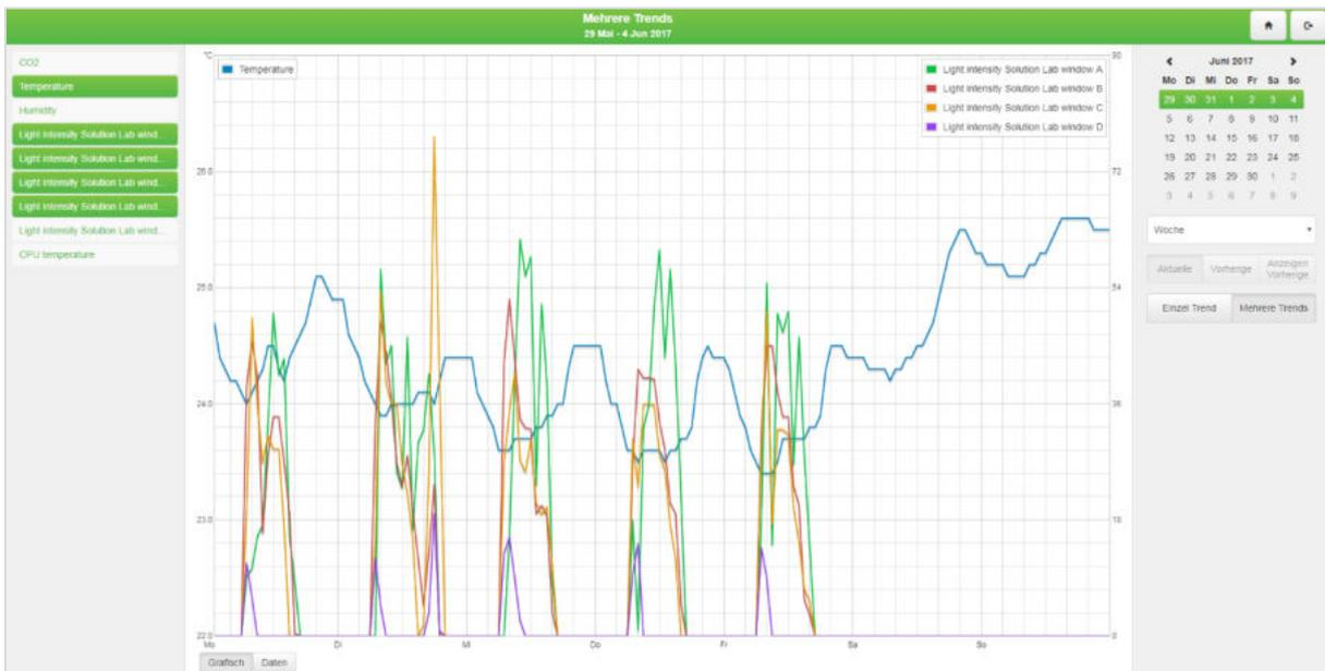
Automatische sekundäre Achse – für zwei Trends mit unterschiedlichen Einheiten/Skalen.
