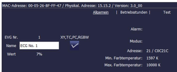
Im Register General wird in der ersten Zeile die EVG Nummer, sowie folgend die möglichen Sub-Types bei DT-8 Geräten angezeigt. Für alle anderen EVG Gerätetypen (DT-0..DT-7) bleibt der Eintrag leer.
