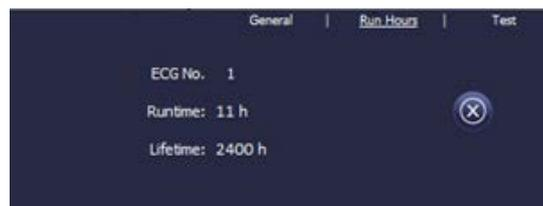
In dieser Darstellung werden die akkumulierten Betriebsstunden seit dem letzten Zurücksetzen sowie die in der ETS festgelegte maximale Lebensdauer der Lampe angezeigt. Über die Taste auf der Seite kann der interne Betriebsstundenzähler auf 0 zurückgesetzt werden.
