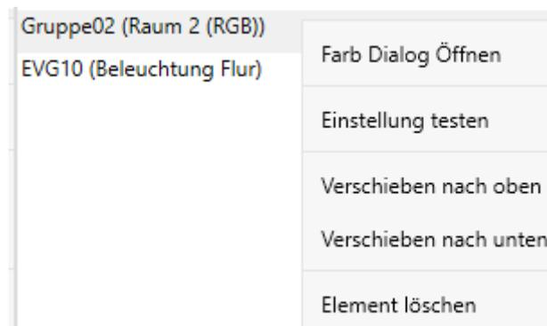
Dazu wird eine Verbindung zum DALI-Gateway benötigt. Der Befehl mit der Einstellung des Wertes und der Farbe wird für diese Gruppe oder EVG ausgeführt. So kann die gewünschte Eigenschaft vor dem Programmieren des gesamten Effektes kontrolliert werden. Falls die Eigenschaften "Wert beibehalten" oder „Farbe beibehalten“ gesetzt sind, werden die entsprechenden Werte nicht aktiviert, sondern auf dem aktuellen Wert beibehalten
