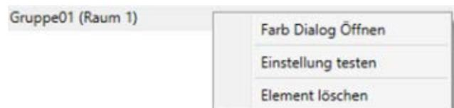
Dazu wird eine Verbindung zum DALI-Gateway benötigt. Der Befehl mit der Einstellung des Wertes und der Farbe wird für diese Gruppe ausgeführt. So kann die gewünschte Eigenschaft vor dem Programmieren der gesamten Szene kontrolliert werden. Falls die Eigenschaften "Wert beibehalten" oder "Farbe beibehalten" gesetzt sind, werden die entsprechenden Werte nicht aktiviert, sondern auf dem aktuellen Wert beibehalten.
