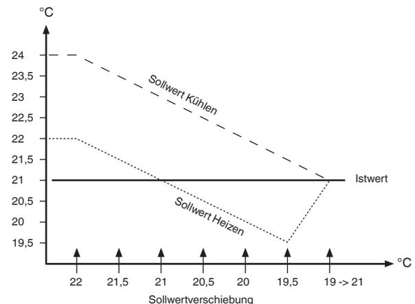
Der Sprung von 19,5 auf 21,0 erklärt sich dadurch, dass nun der Sollwert Kühlen relevant wird, da die Isttemperatur größer oder gleich der Solltemperatur Kühlen ist. Je nach Einstellung wirkt diese Sollwertverschiebung auf alle Betriebsarten oder nur auf die aktuelle Betriebsart.
