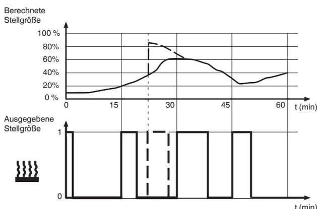
Bei Solltemperaturänderung berechnet der Regler die erforderliche Stellgröße neu und sendet sie noch innerhalb des aktuellen Zyklus (gestrichelte Linie).
