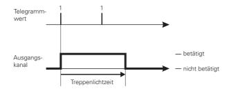
retriggerbar: Nach dem Empfang eines neuen Telegramms mit dem Objektwert "1" wird die Treppenlichtzeit neu gestartet.
