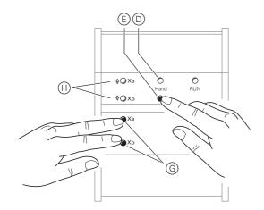
Nach 3 s blinkt die Handbetriebs-LED (D) und die Kanalstatus-LEDs (H) zeigen den Zustand der Kanäle an:
