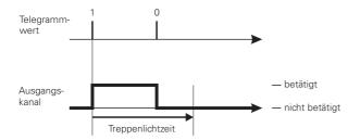
ohne manuell-AUS: Ein Telegramm mit dem Objektwert "0" hat keine Auswirkungen. Die eingestellte Treppenlichtzeit läuft bis zum Ende normal weiter. Eine Ausschaltverzögerung ist nicht einstellbar.
