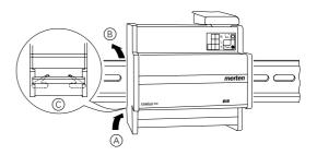
(1) Setzen Sie den Aktor von unten auf die Hutschiene (A) und schieben Sie ihn nach oben. Dann drücken Sie ihn oben an (B), so dass die Krallen auf der Rückseite in der Schiene fixiert sind ©.
