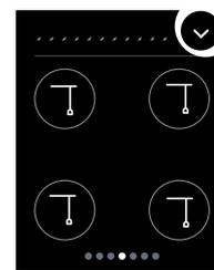
Im Dreh-Design stellen Sie die Jalousie auf der Hauptseite ein, die Lamellen verstellen Sie auf eine weiteren Unterfunktionsseite. Beim Vertikal-Design sind Jalousie- und Lamellenfunktion auf einem Bildschirm zusammengelegt. Mit dem Tasten-Design können Sie bis zu 4 Jalousien auf eine Bildschirmseite bedienen, je nach Konzeption.
