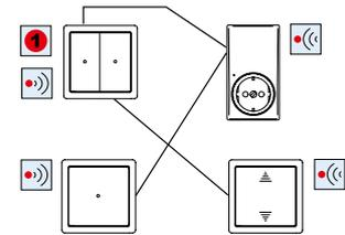
**i** Der Funk-Taster CONNECT 1fach erhält immer die Funktion der linken Taste des Systemverwalters.
