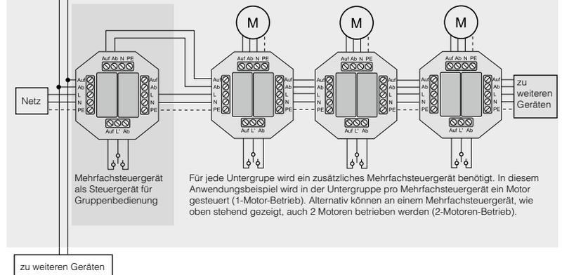
Mehrfachsteuergerät als Steuergerät für Gruppenbedienung
