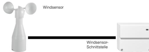
Der Windsensor (Art.-Nr. 580692) wird auf dem Dach oder an der Hauswand montiert. Er muss an einer für die Windstärkemessung günstigen Position angebracht werden. Das Gerät daher nicht im Windschatten montieren. Auf lagerichtige Anbringung achten. Der Sensor mit Heizung (Art.-Nr. 580690) ist für störungsfreien Betrieb im Winter geeignet. Für die Heizung ist ein separates Netzteil erforderlich.
