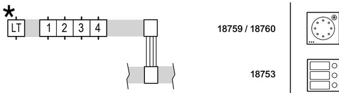
Module des neuen Portier Programms mit den Artikel-Nr. **187...** können zur Erweiterung einer vorhandenen modularen Türstation oder zum Austausch von vorhandenen Modulen mit den Artikel-Nr. **147...** kombiniert werden. In diesen Fällen ist ein Kreuzverbinder Artikel-Nr. **18797** einzusetzen (Kreuzverbinder Artikel-Nr. **18797**, nähere Angaben finden Sie im TwinBus System-Handbuch [ZXRGE1105210/12.15/3.AT](#)).
