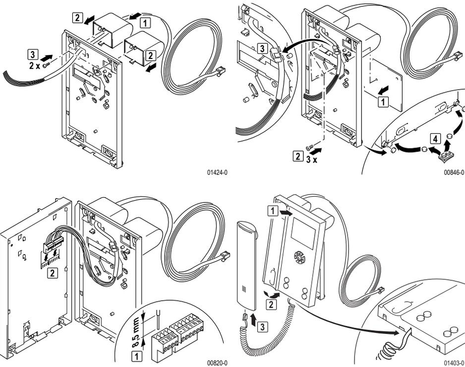
► IAE/UAE-Anschlussdose gemäß Tabelle anschließen und montieren.
