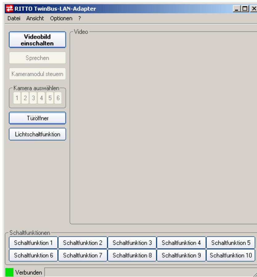
Auf der linken Seite befinden sich Schalter für Videobild, Gesprächsannahme, Kameraumschaltung, Türöffner und Licht. Im unteren Bereich finden Sie Schalter, die für beliebige Schaltfunktionen verwendet werden können.
