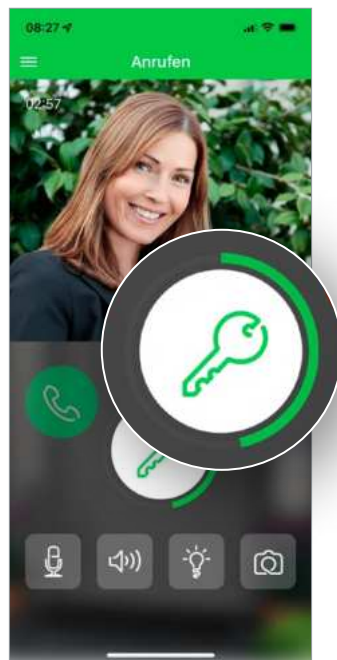
Sicheres Türöffnen durch langes Betätigen des Türöffner-Buttons
